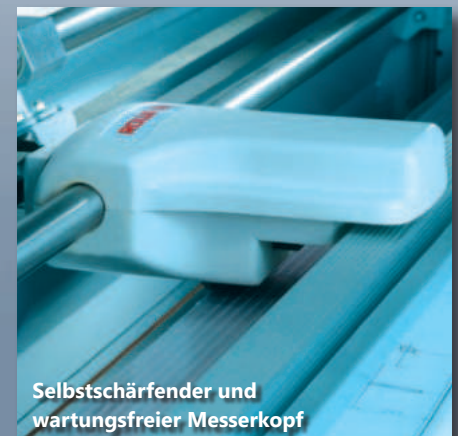
Effizientes Schneiden durch Kurztastbetätigung
